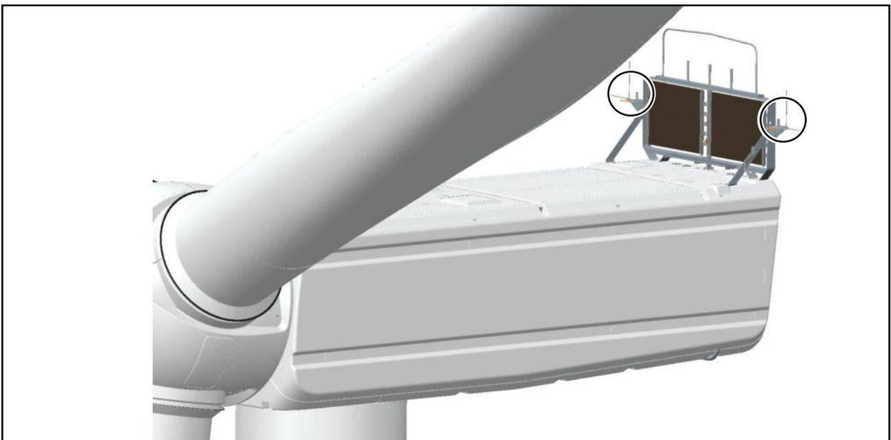
Abb. 1: Beispielhafte Verbauposition Gefahrenfeuer bei Delta4000
