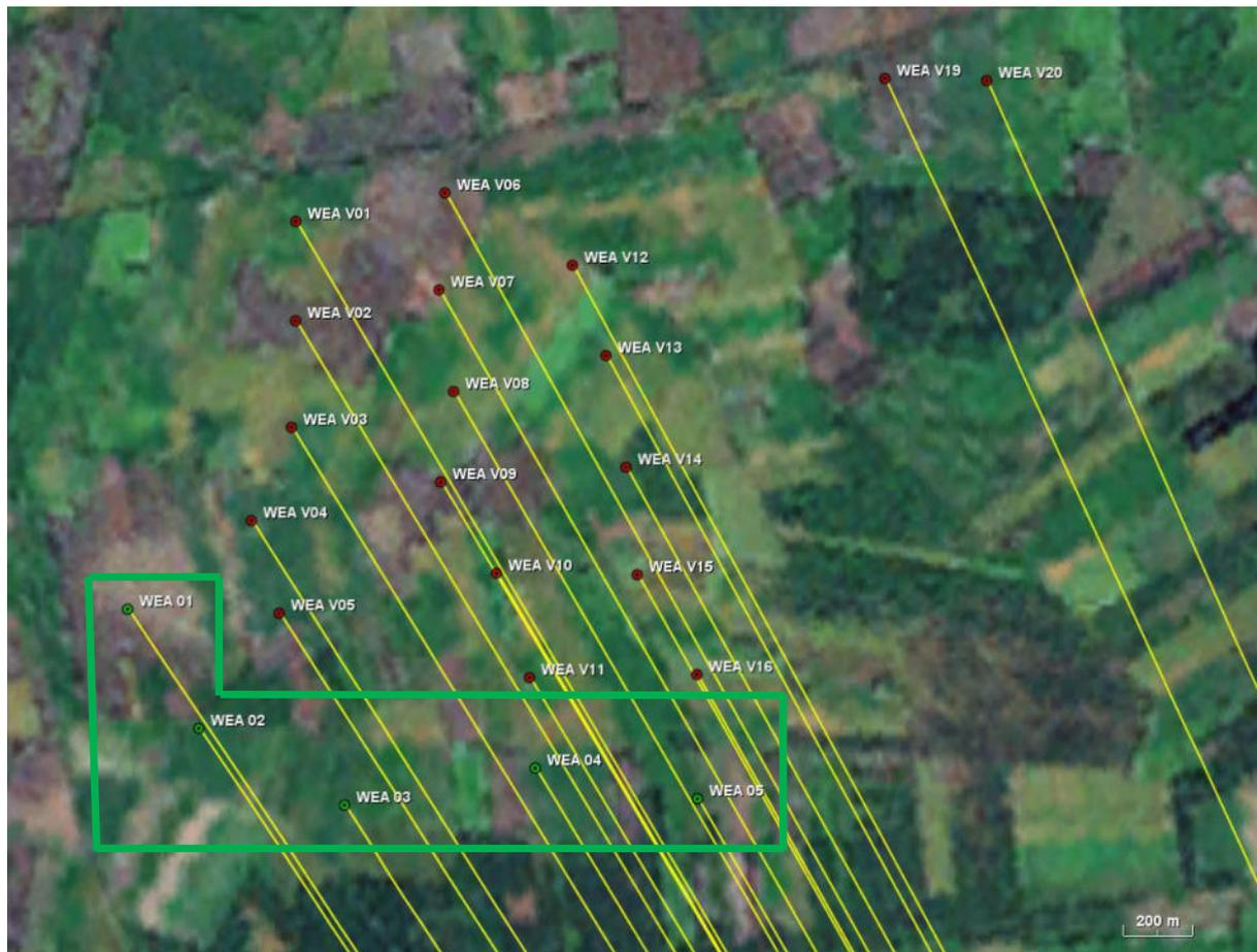
Abbildung 2: Detailübersicht über den Windpark Bartelsdorf mit den geplanten Windenergieanlagen (grün) und den Bestandsanlagen (rot). Die Einstrahlungsrichtungen bzgl. der Radaranlage Visselhövede sind gelb dargestellt.
