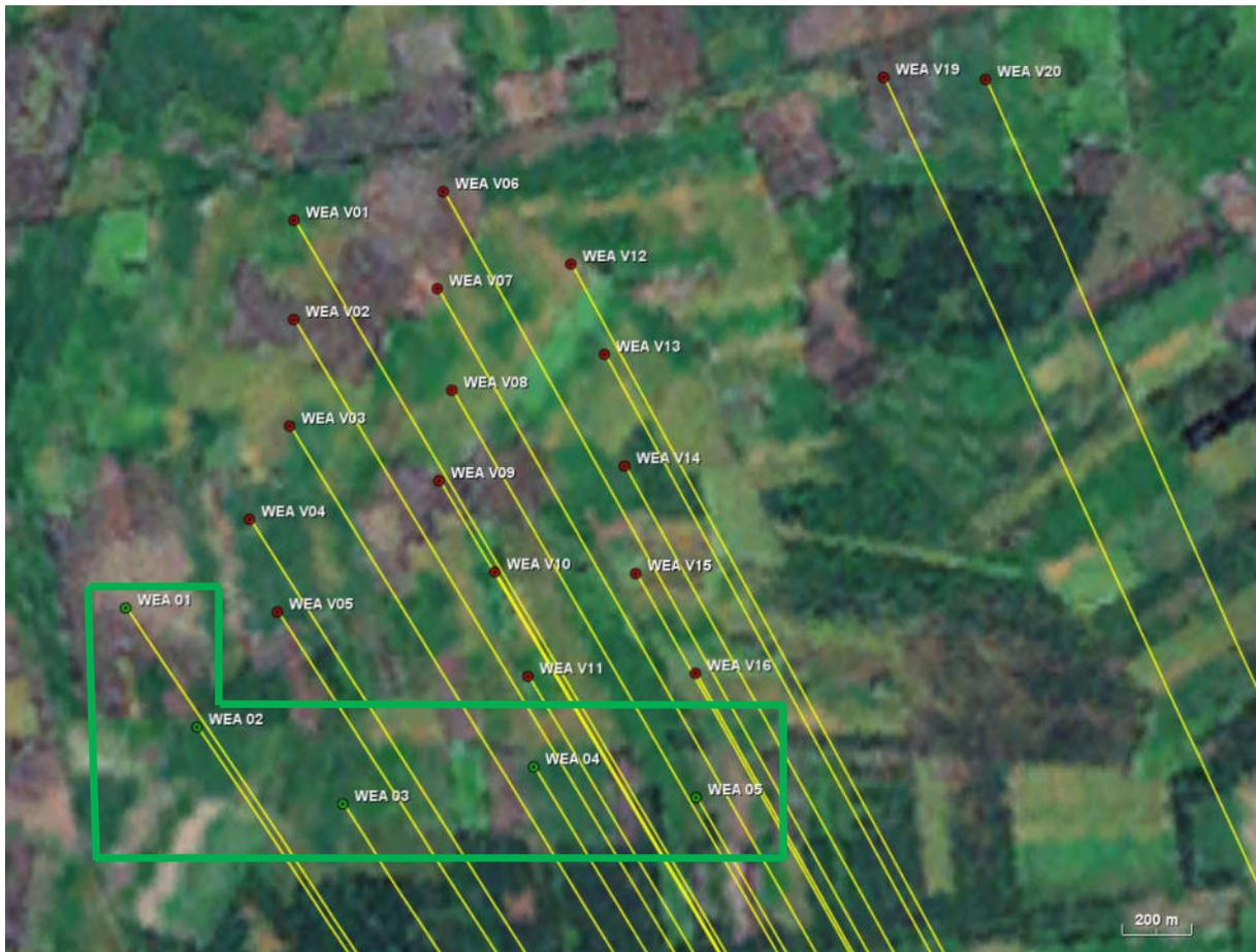
Abbildung 13: Detailübersicht über den Windpark Bartelsdorf mit den geplanten Windenergieanlagen (grün) und dem Bestand (rot). Die Einstrahlungsrichtungen bzgl. der Radaranlage Visselhövede sind gelb dargestellt.
