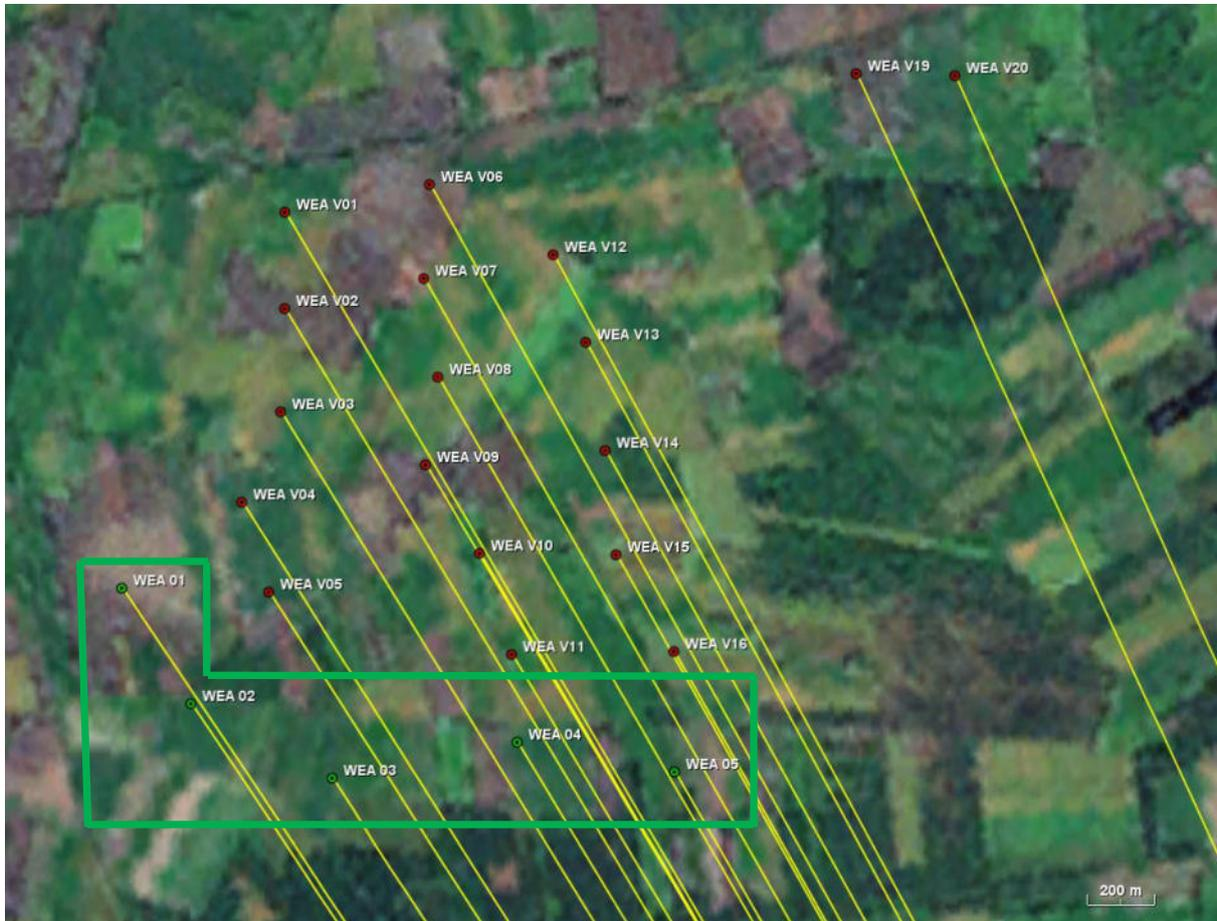
Abbildung 4: Detailübersicht über den Windpark Bartelsdorf mit den geplanten Windenergieanlagen (grün) und dem Bestand (rot). Die Einstrahlungsrichtungen bzgl. der Radaranlage Visselhövede sind gelb dargestellt.
