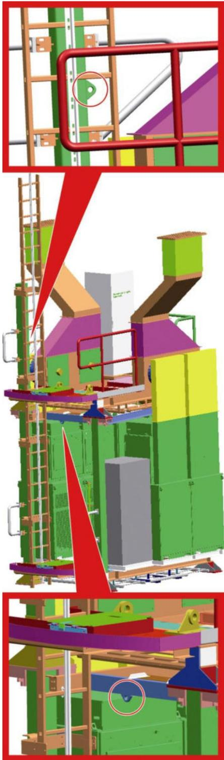
Abb. 24: Anschlagpunkte Umrichtersektion
