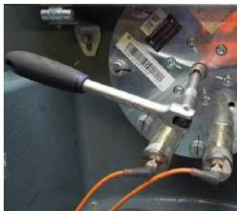
Abb. 16 : Einlegen der Rotorarretierung
